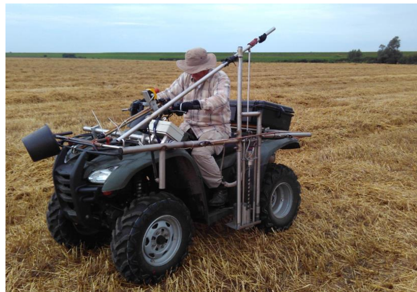
Pojazd pomiarowy przystosowany do pomiaru powierzchni działek oraz pobierania próbek glebowych
