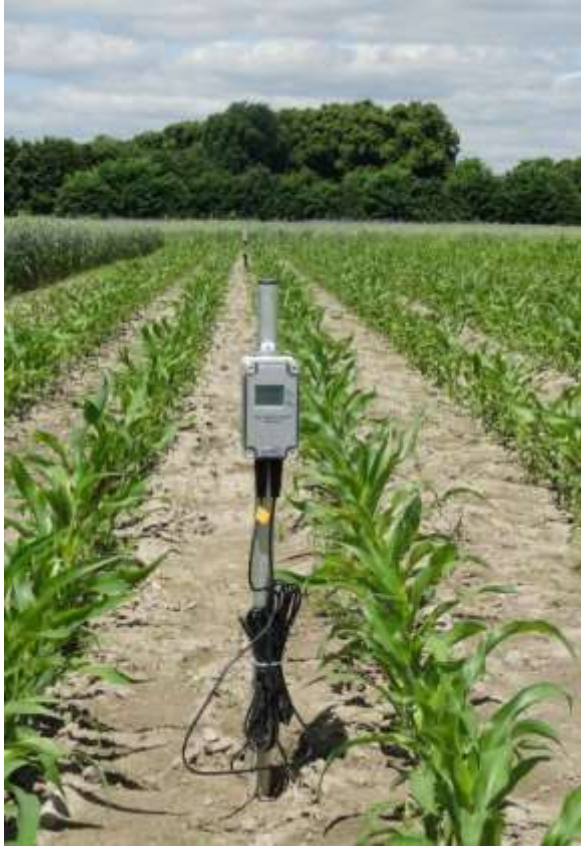
EC5 Decagon – dokładność \pm 3\%VWC – 2014 – 2016, co 10 min
