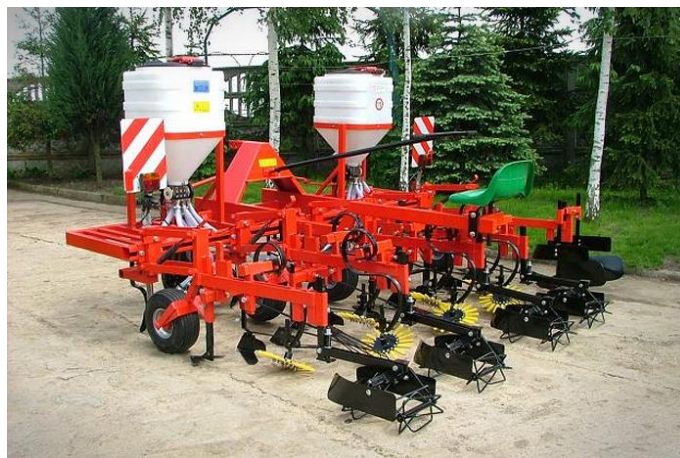
Eko-Pielnik „Łuczak” – przykład maszyny do pielenia szczotkowego z możliwością aplikacji nawozów dogłębnych typu pro-bio-emów. źródło : www.luczakmaszyny.com
