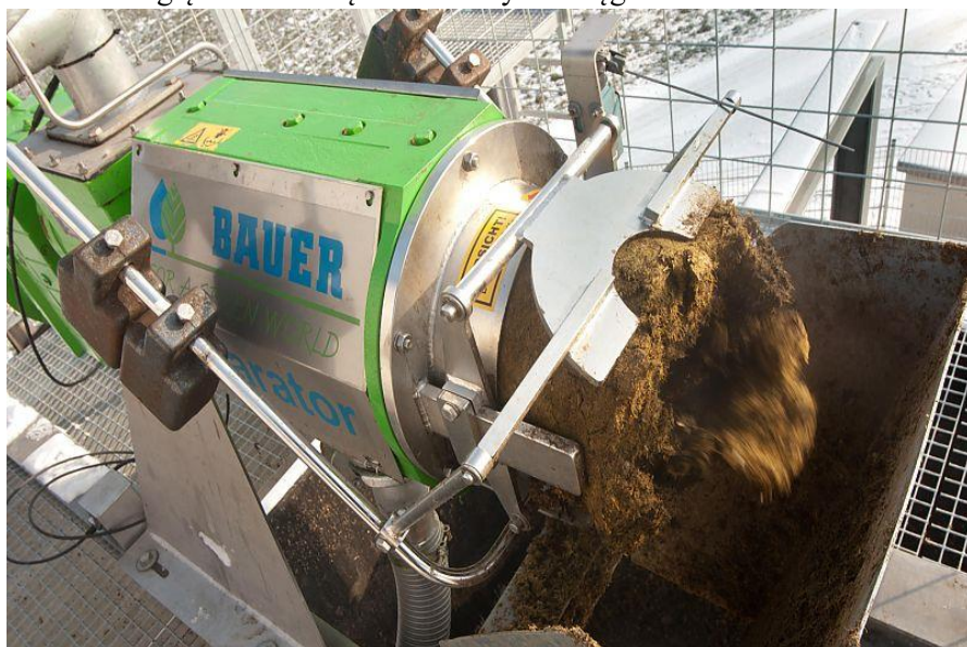
fot. 1. Frakcja stała gnojowicy oddzielona za pomocą separatora
